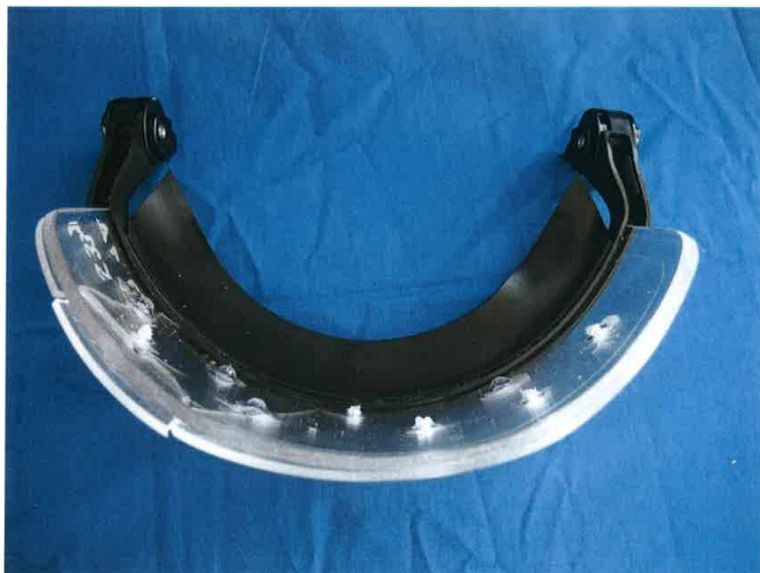
Trhliny, naštiepenie a delaminácia štítu
