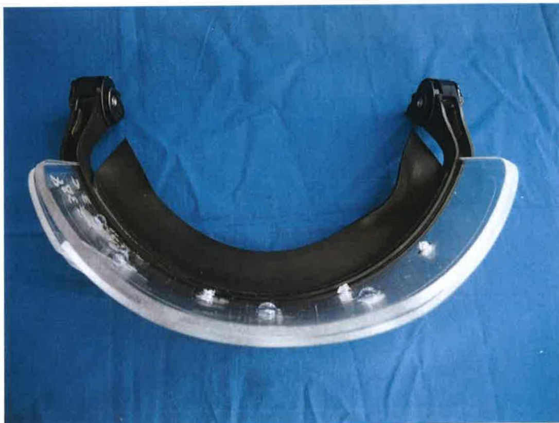
Riss und Delamination der Sichtscheibe
