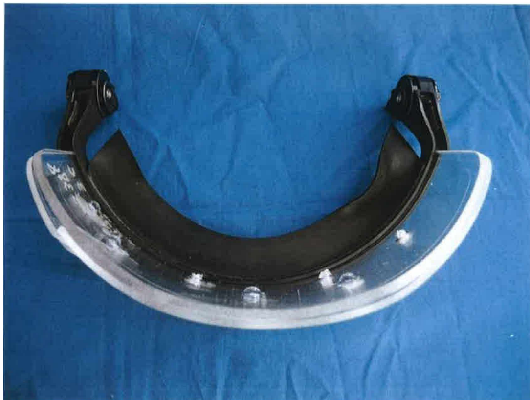
Trhlina a delaminácia štítu
