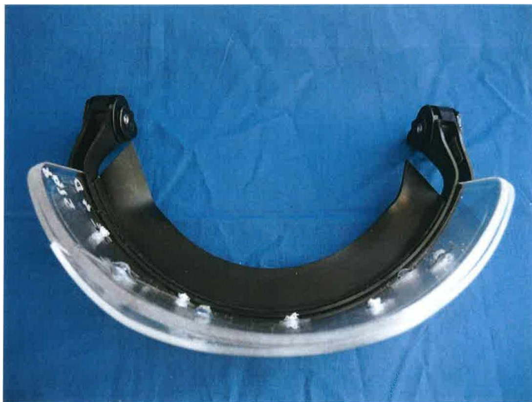
Trhlina a delaminácia štítu
