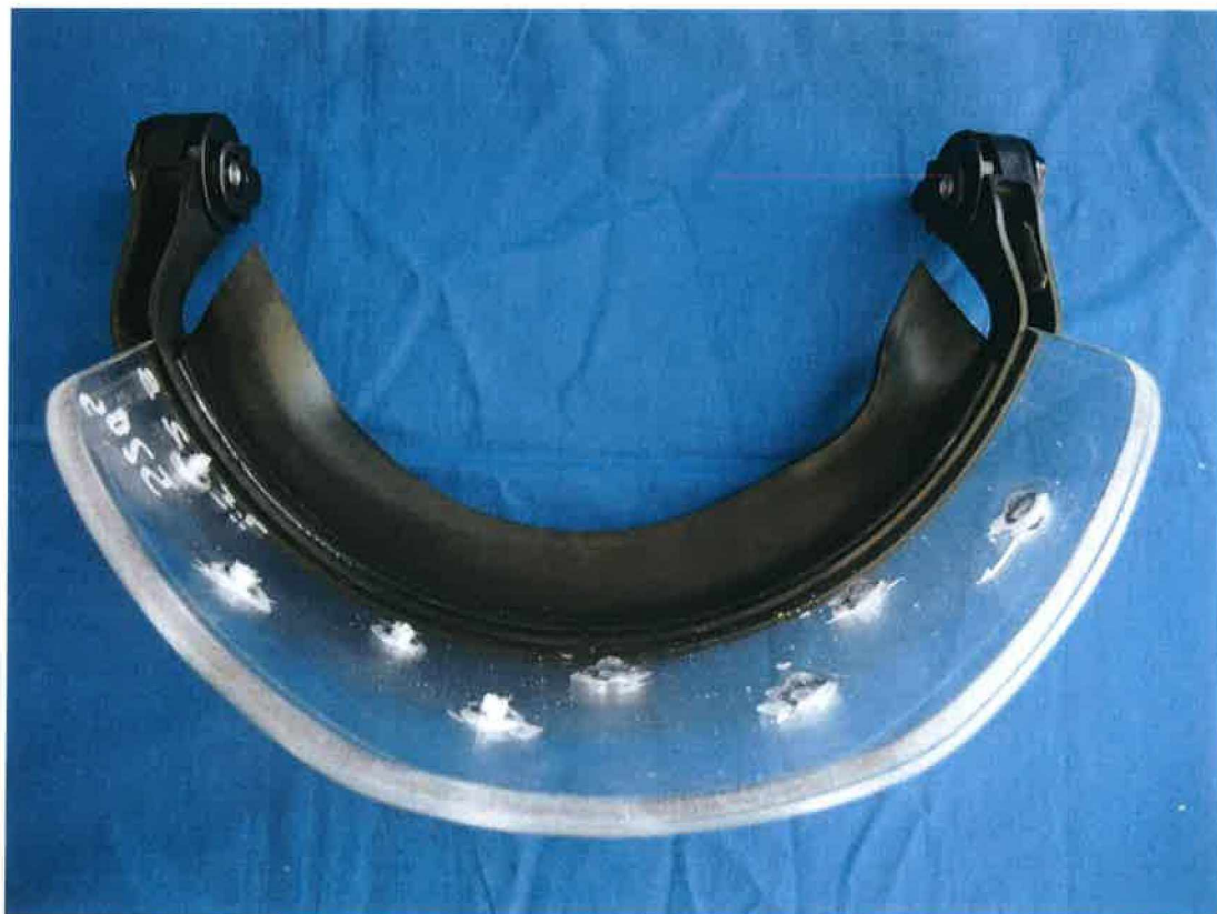
Delamination der Sichtscheibe
