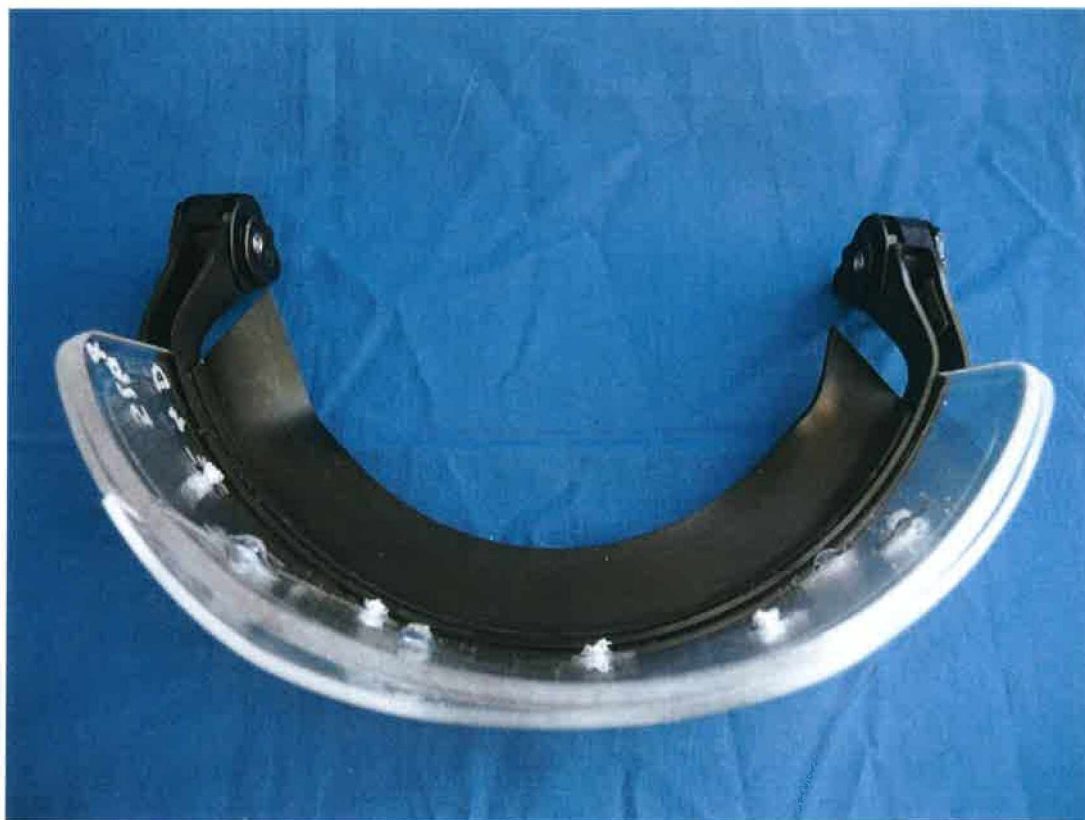
Riss und Delamination der Sichtscheibe
