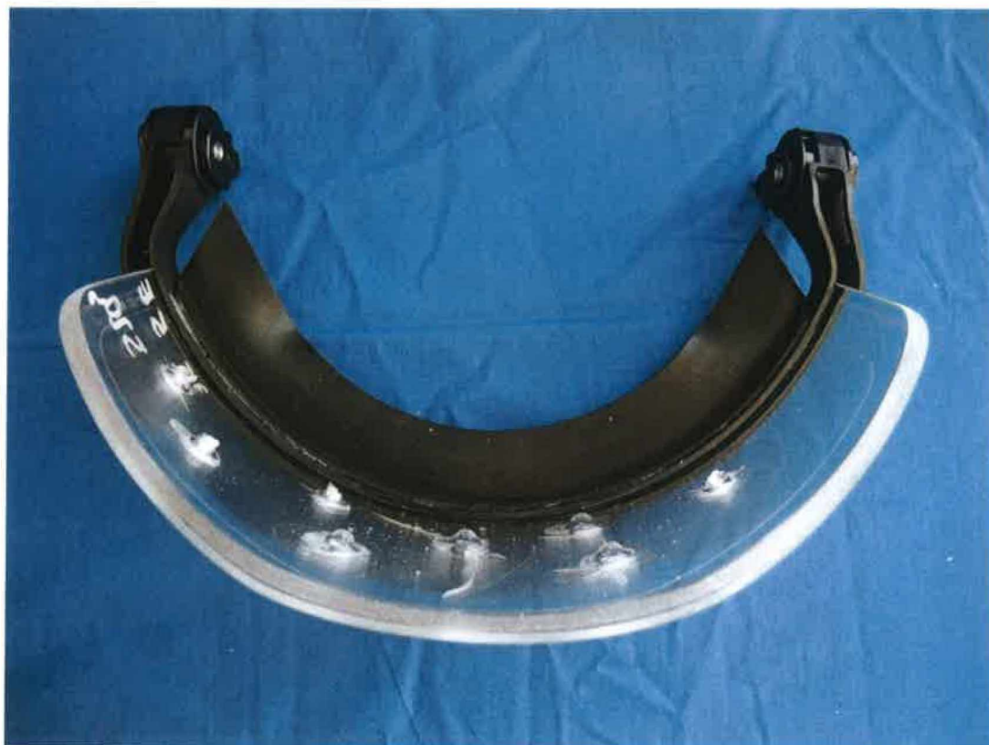
Riss und Delamination der Sichtscheibe
