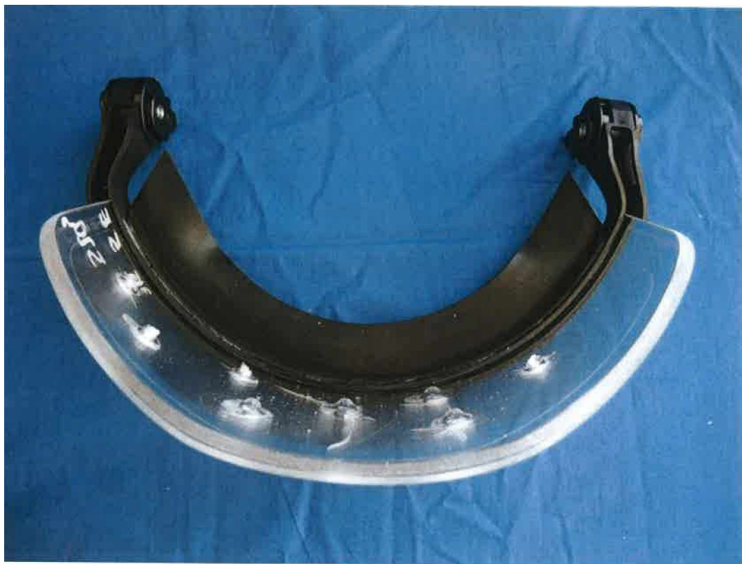
Trhlina a delaminácia štítu
