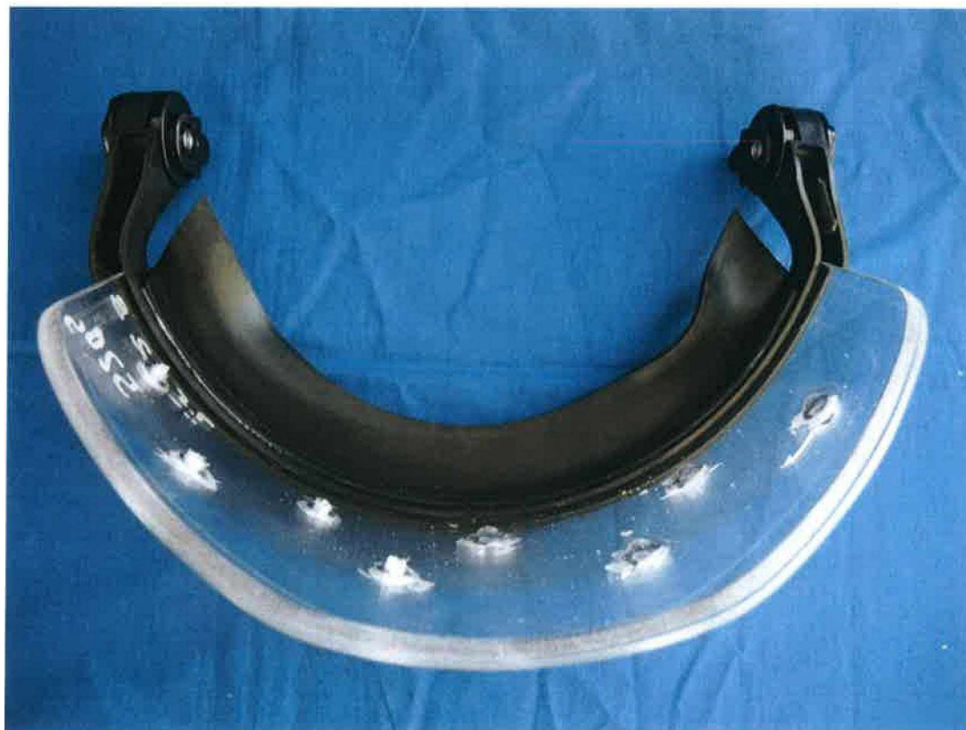
Delaminácia štítu
